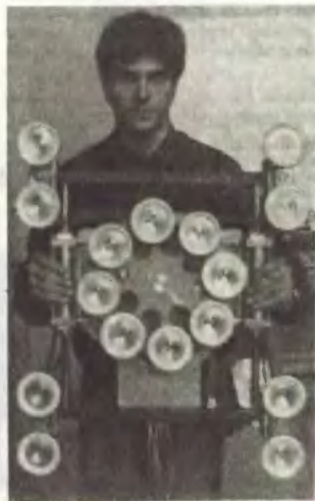
Электромеханик В. Нецветай демонстрирует 16 присосок, с помощью которых робот держится на вертикальной плоскости.
